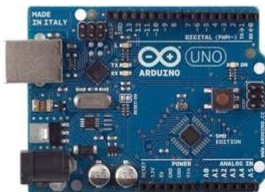
รูปที่ 1.7 บอร์ดไมโครคอนโทรลเลอร์ Arduino Uno R3
